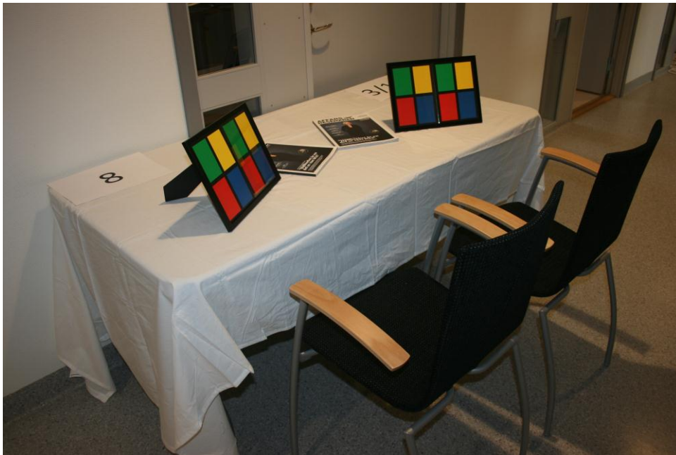
Figur 8. Samma försöksupställning användes i tillämpningsmiljön som i laboratoriet, vilket inkluderade färgkartor i ram med och utan glas, samt en tidskrift.
