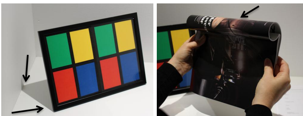
Figur 5. Bedömningspunkter för bländning, flimmar och ljuskällans gulhet överst, för de olika skuggningarna från fotoramen till vänster och reflex i tidskrift till höger.
