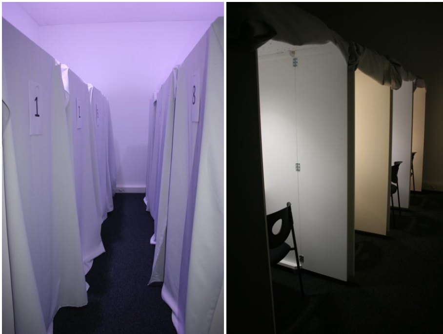
Figur 1. Försöksbås i det multisensoriska laboratoriet på SP i Borås. Till vänster syns bås 1-8, utrustade med ogenomskinliga draperier. Till höger ses fyra bås där ljuskällor med olika färgtemperatur monterats.
