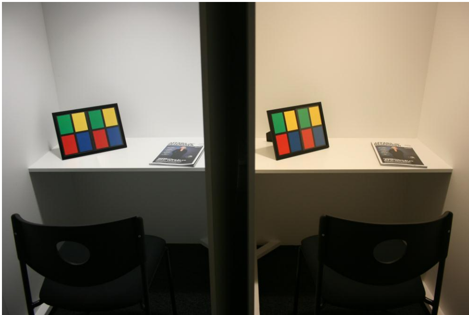
Figur 2. Slutgiltig uppsättning av objekt som används för bedömning av sensoriska belysningsparametrar; två färgkartor i en fotoram med och utan glas, samt ett magasin.
