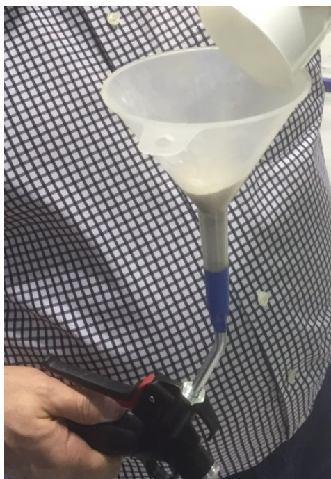
Bild 6. Tratt ansluten till tryckluftpistol och fylld med konstgjort damm
