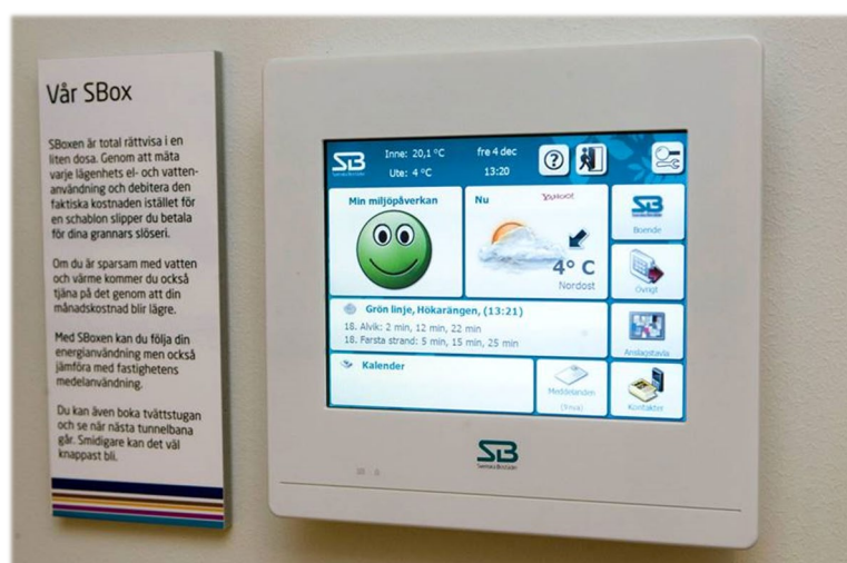
Figur 1. Svenska bostäders SBOX med förbrukningsdata.
