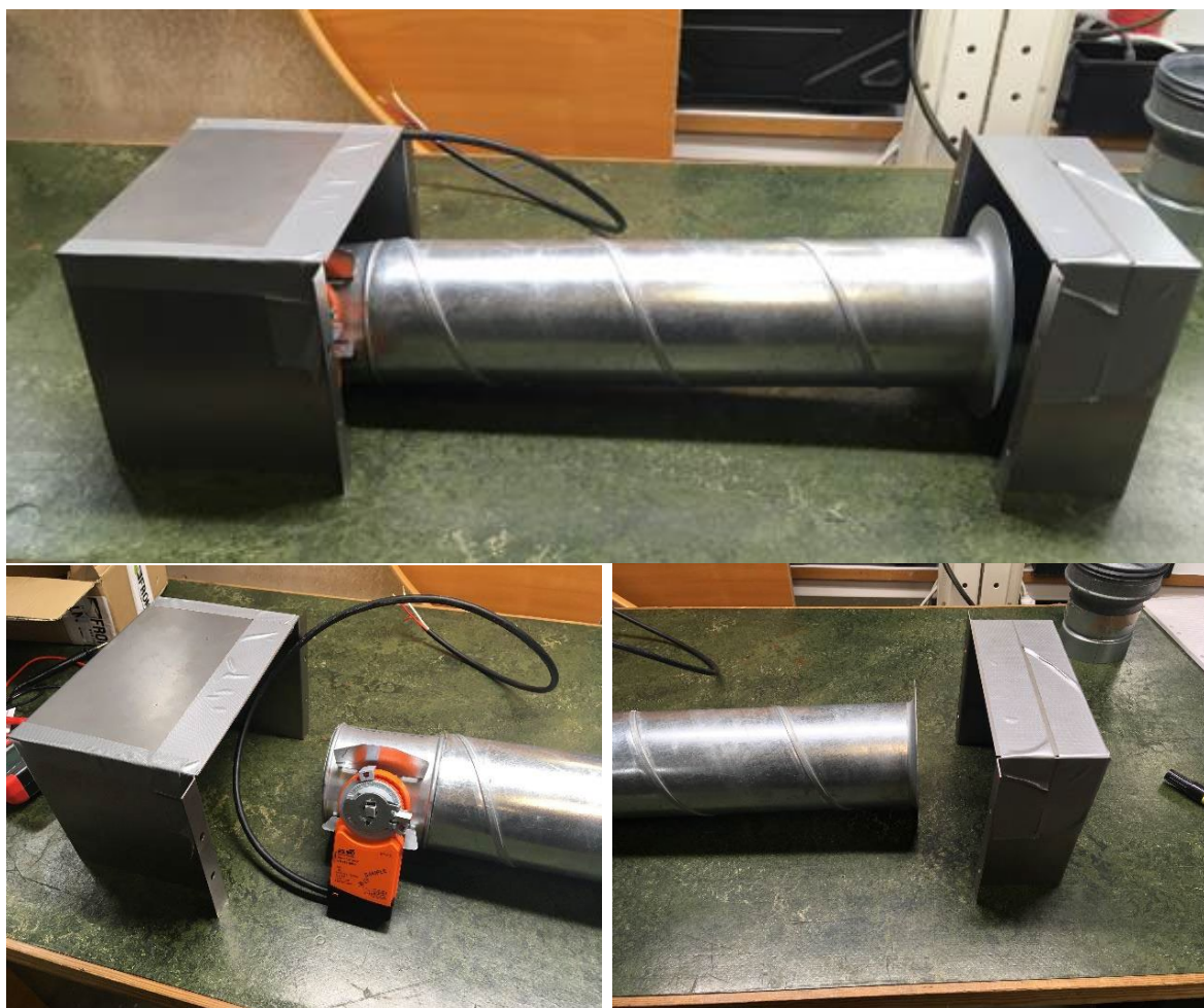
Figur 4. Foto av Bidrag 2. Det översta fotot visar lösningen i sin helhet med cirkulär kanal med spjället för ersättningsluft till vänster i bild under en skyddskåpa. Nere till vänster visas spjället för ersättningsluft, nere till höger visas luftintaget med väderskyddande kåpa.
