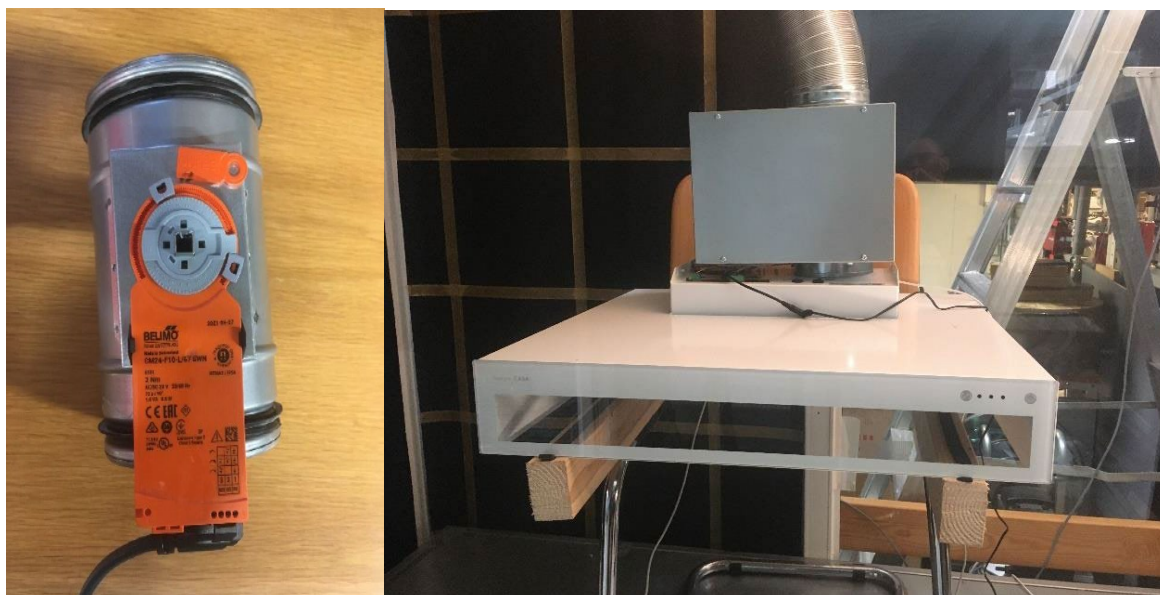
Figur 3. Foto av testobjekt 1. Fotot till vänster visar spjället för ersättningsluft. Fotot till höger visar spiskåpan uppställd i laboratoriet.
